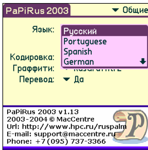
Рисунок 26. Кроме русского, можно выбрать любой из имеющихся на КПК языков. Русификатор при этом отключается.
